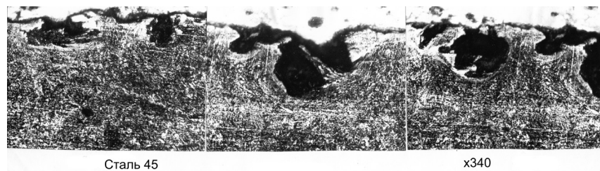
Рис. П3. Микрорельеф поверхности стали 45
