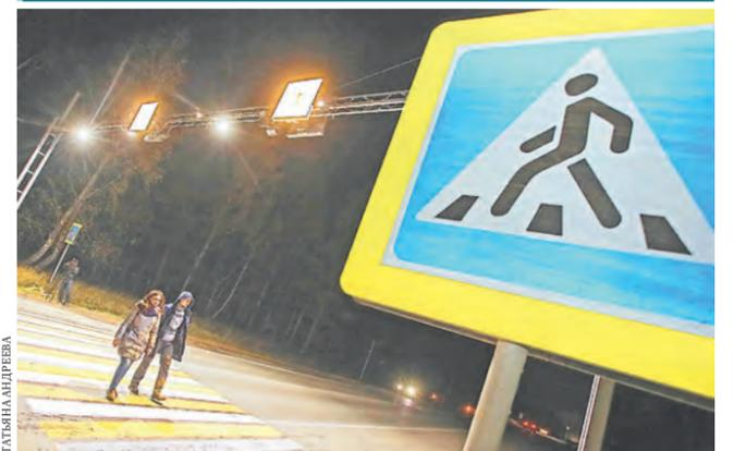
Впервые в Свердловской области экспериментальная проекционная дорожная разметка нанесена на 12 нерегулируемых пешеходных переходов. Один из них — на Полевском тракте. Три светодиодных проектора с цветными фильтрами размещены на П-образной опоре. Такая бело-желтая «зебра» не сотрется со временем, хорошо заметна в темноте при любой погоде. Для установки оборудования выбрали место, где у пешеходов высок риск оказаться под колесами автомобиля.
