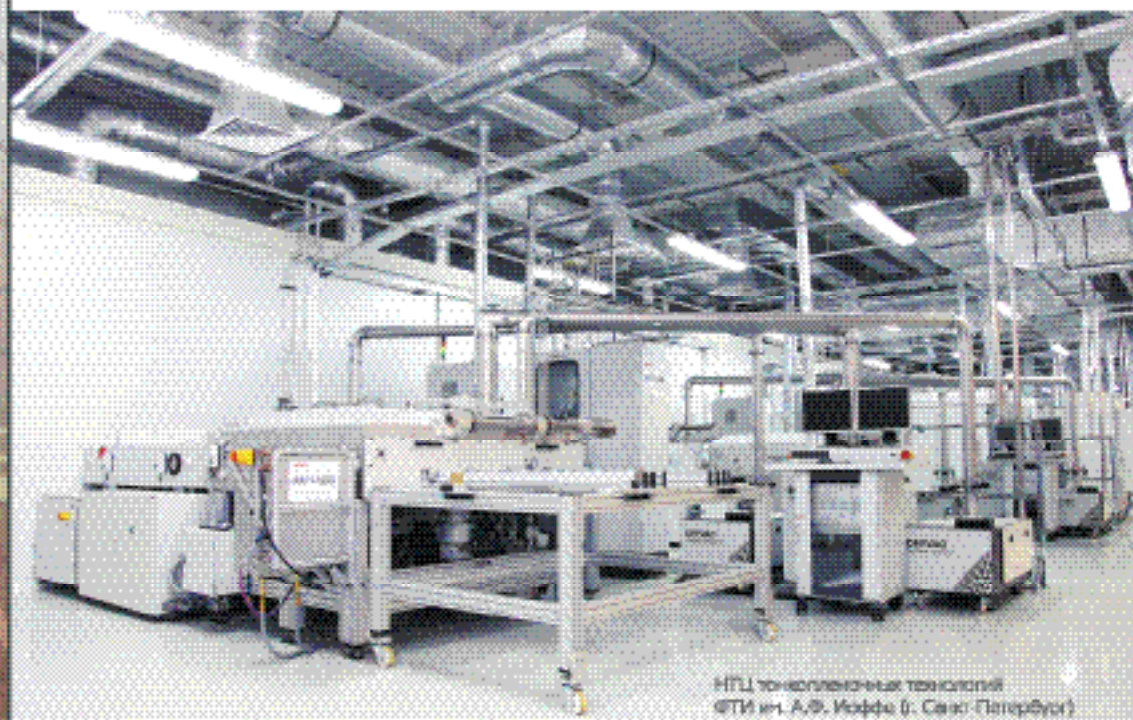
Технология прямого формирования рисунка при производстве печатных плат
