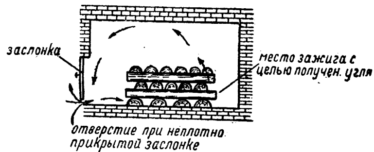
Рис. 1. Разрез топки русской печи. Стрелками показано движение воздуха и дыма.
