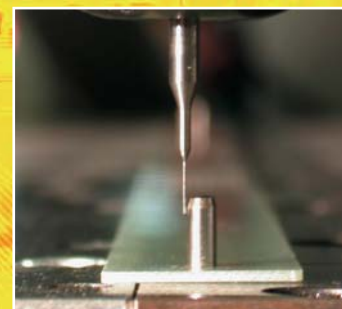
Платы печатные. Сверление микроотверстий
