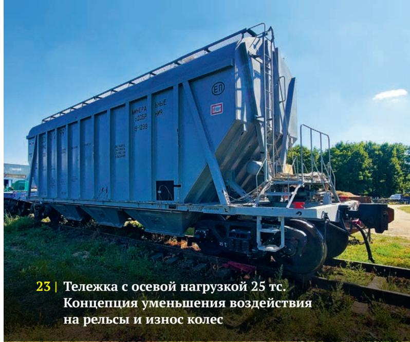
23 | Тележка с осевой нагрузкой 25 тс. Концепция уменьшения воздействия на рельсы и износ колес
