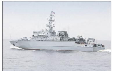
В ходе серии испытаний на морских полигонах боевой подготовки ТОФ экипаж совместно с представителями промышленности проверит работоспособность систем и механизмов тральщика в море: работу силовой установки, рулевого устройства, вспомогательных механизмов, средств связи, обнаружения и навигации, якорного устройства. Также будут проведены испытания корабельного оружия.
