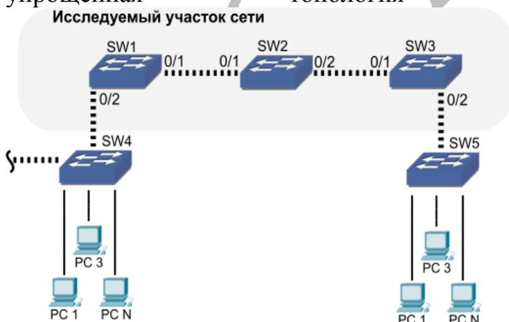
Объектом исследования являются 3 коммутатора Cisco 2940 (SW1,SW2,SW3), работа остальных коммутаторов (SW4, SW5) не учитывается. Начиная работу, студент проверяет работоспособность сети командой ping и средствами ПО WireShark «захватывает» пакеты и наблюдает и анализирует их в окне программы.
