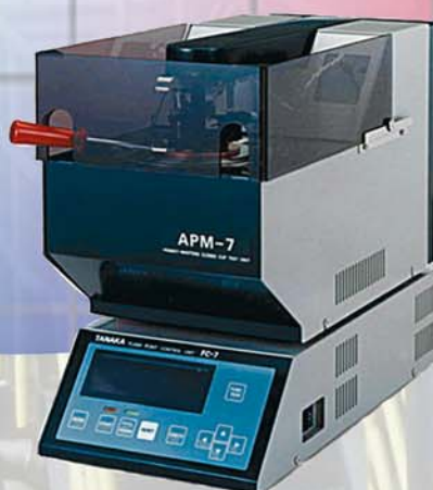
Аппарат для определения температуры вспышки APM-7 (Tanaka, Япония)
