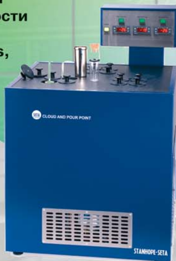
Баня для определения температур помутнения и застывания 94100-0 (Stanhope-Seta, Великобритания)
