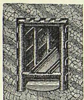
Фиг. 4. Штреки и штольни съ деревяннымъ крѣплениемъ.
