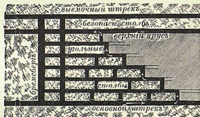
Фиг. 7. Столбовая выемка.
