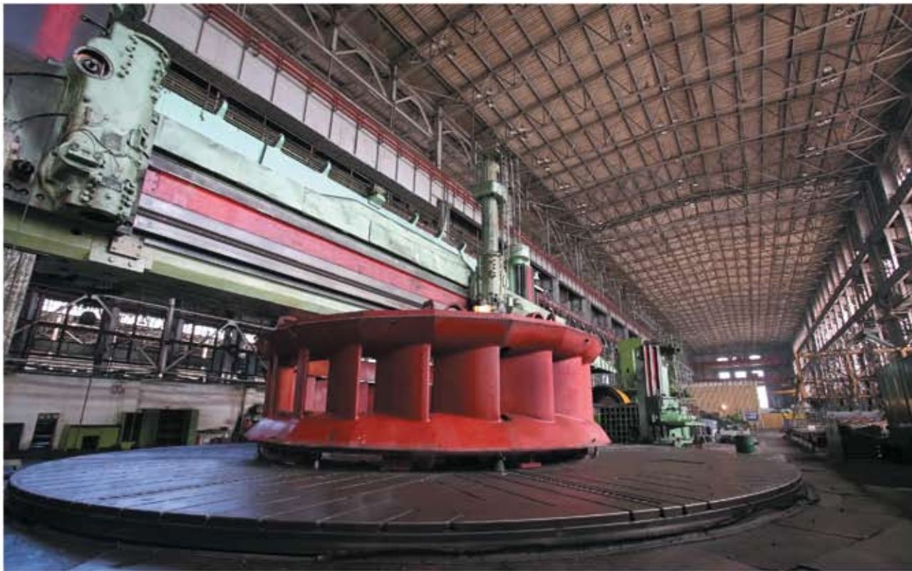
Обработка статора ГЭС на станке К 19М
