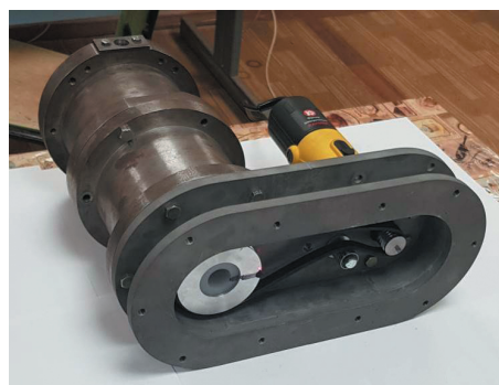
Рис. 2. Устройство для вращения крешера
