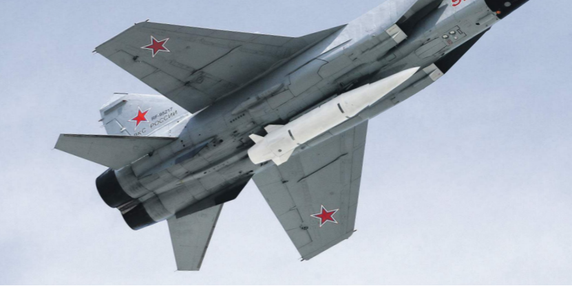
В составе комплекса «Кинжал» самолет выполняет роль разгонной ступени | Александр Казаков | «Известия»
