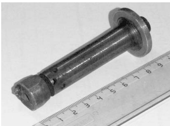
Рис. 1. Общий вид плазмотрона «Флейта»
