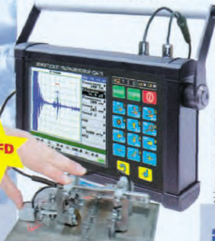
ультразвуковой дефектоскоп- томограф УД4-76
