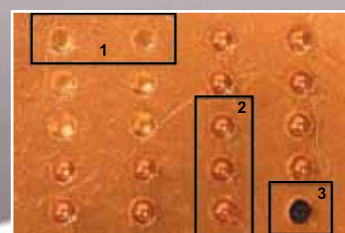
Особенности заполнения отверстий в монтажных контактных площадках печатных плат непроводящими материалами
