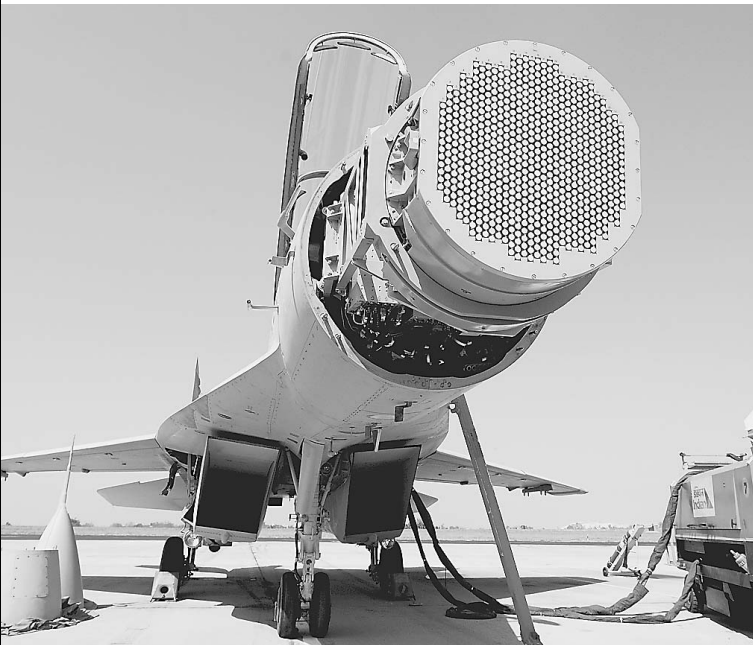
Под обтекателем «МиГа» — 600 приемопередатчиков, похожих на пчелиные соты
