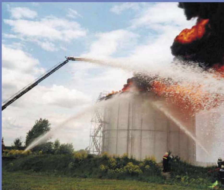
Установка комбинированного тушения пожаров «Пурга» в действии
