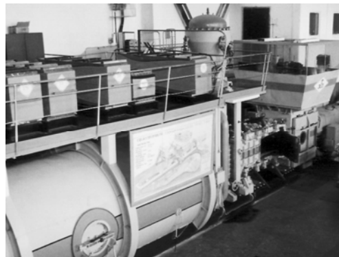
Сверхзвуковая аэродинамическая труба Т-313 ( M = 1,75 \div 7 ).
