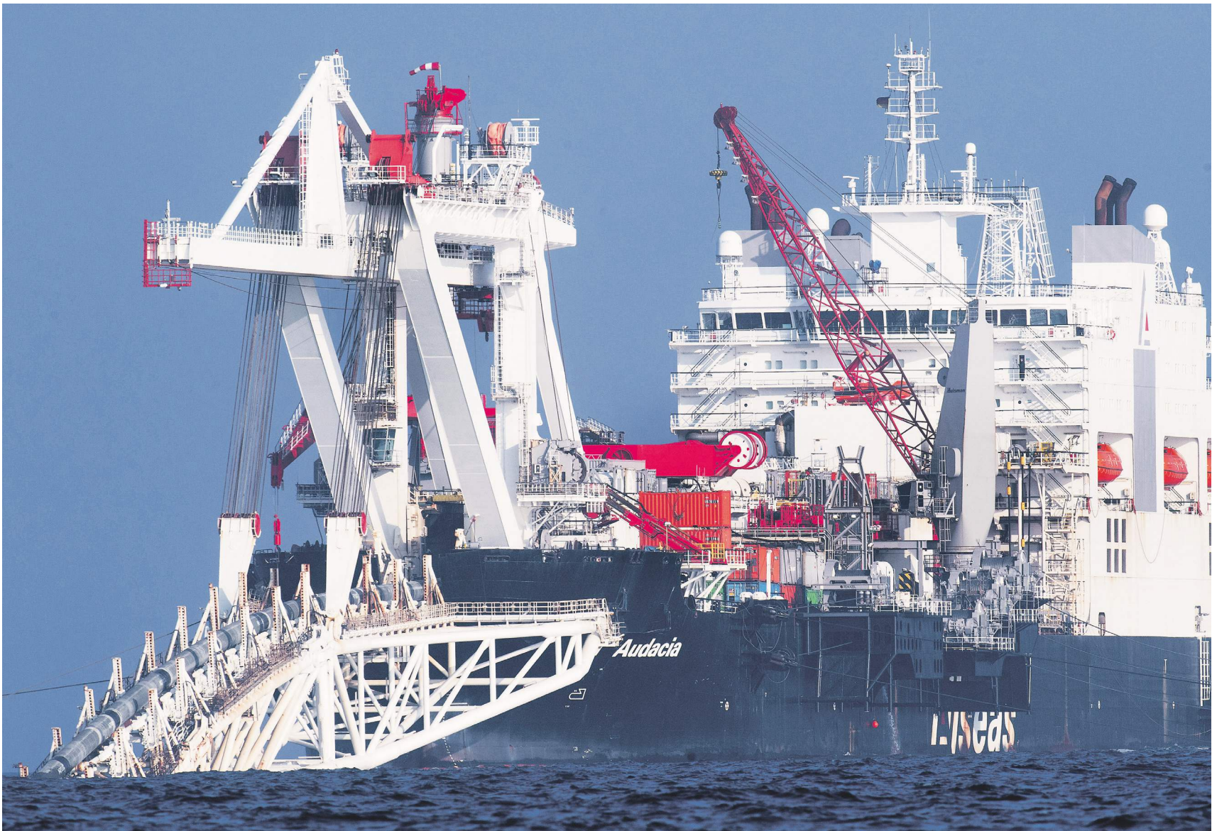
Судно Audacia, принадлежащее фирме Allseas, прокладывает трубы для «Северного потока-2» у острова Рюген
