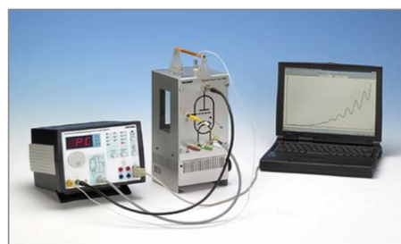
«Эксперимент Франка-Герца с ртутной трубкой»
