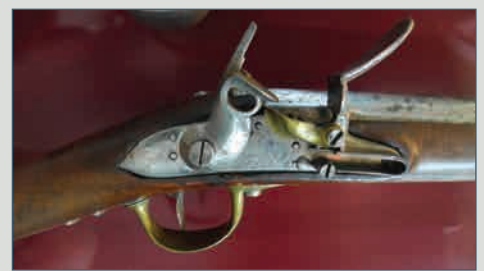
Спусковой механизм французского мушкета
