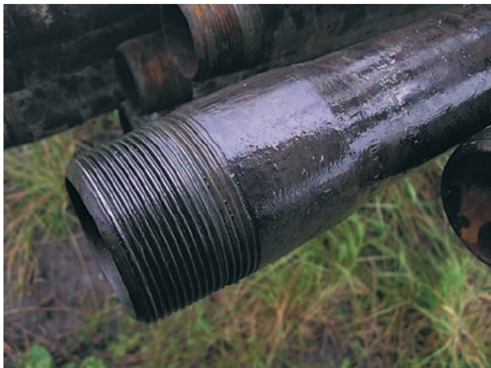
Рис. 6.2. Внешний вид резьбового конца НКТ после промышленных испытаний в нефтяной скважине в течение 40 мес
