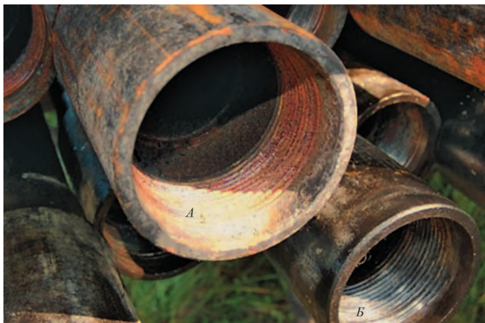
Рис. 7.2. Внешний вид муфт с гальваническим (А) и диффузионным (Б) цинковым покрытием после испытаний в нефтяной скважине в течение 3 лет и 8 мес
