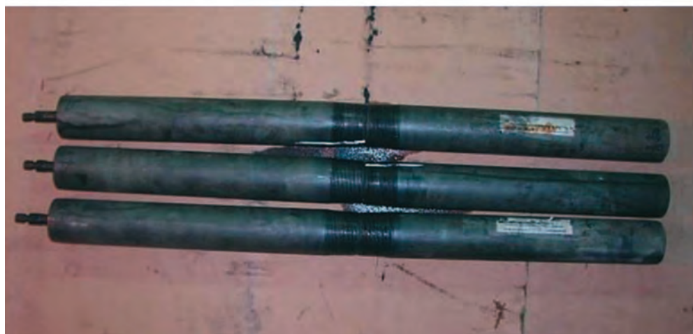
Рис. 5.20. Муфты (разрез) и НКТ группы прочности Д после гидроиспытаний коррозионной средой по методике NACE: образцы полностью погружали в испытательный раствор NACE
