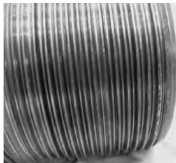
Рис. 5.18. Образец резьбового соединения НКТ после проведения 100 циклов имитации СПО в лабораторных условиях
