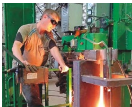
Стр. 43 Электрошлаковая сварка
