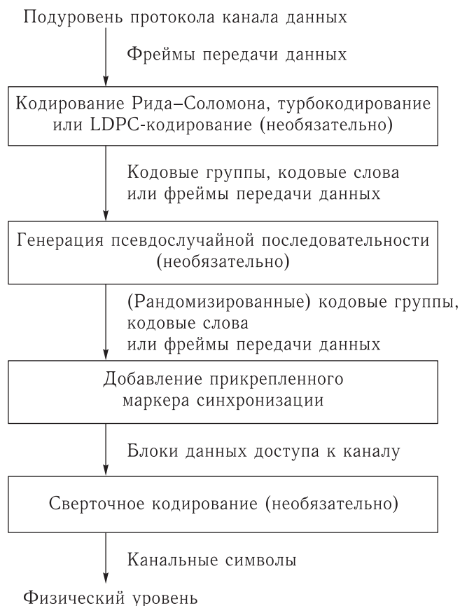
Рис. 2. Внутренняя организация подуровня синхронизации и кодирования каналов стороны источника информации
