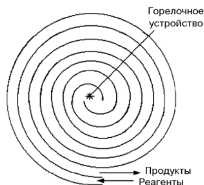
Рис. 3. Регенеративная горелка с двойной спиралью
