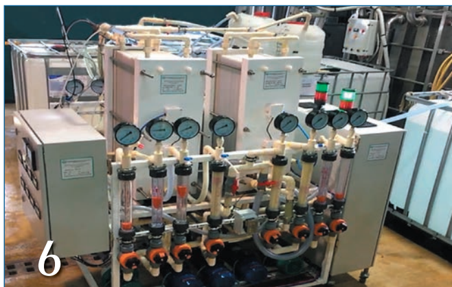
ТЕХНОЛОГИЯ И ОБОРУДОВАНИЕ МТЛТ ДЛЯ ДЕМИНЕРАЛИЗАЦИИ ЛАКТОЗОСОДЕРЖАЩЕГО СЫРЬЯ С ПОВЫШЕННЫМ СОДЕРЖАНИЕМ СУХИХ ВЕЩЕСТВ
