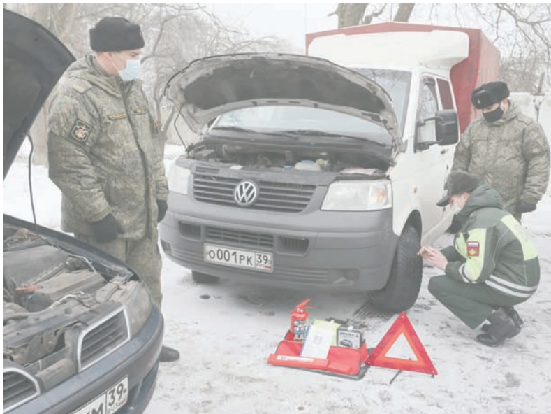
Замер высоты протектора автошины.
