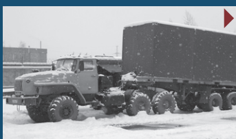
МКО-1000 очистка (мойка) резервуа- ров до 20 тыс. м 3
