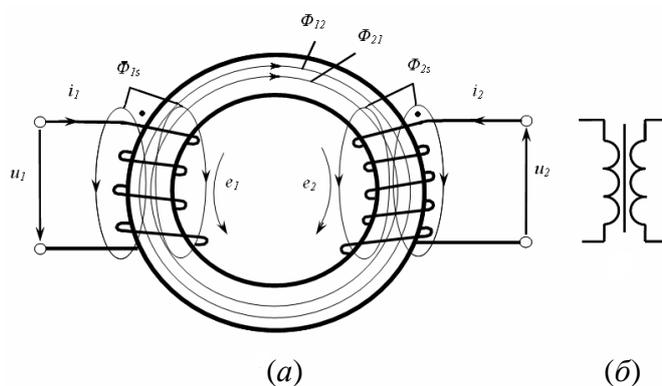
**Рис. 1.1.** Принципиальная схема однофазного двухобмоточного трансформатора (а) и его условное обозначение (б)
