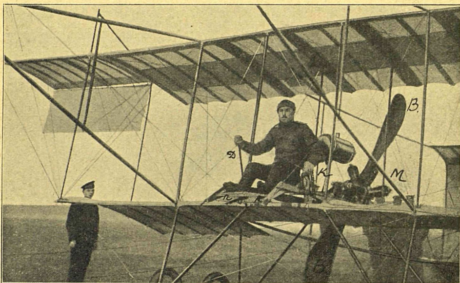
2. D —рычагъ рулей высоты и крылышекъ боковой устойчивости; H —рычагъ рулей направленія; K —управленіе моторомъ; M —моторъ; B —винтъ.
