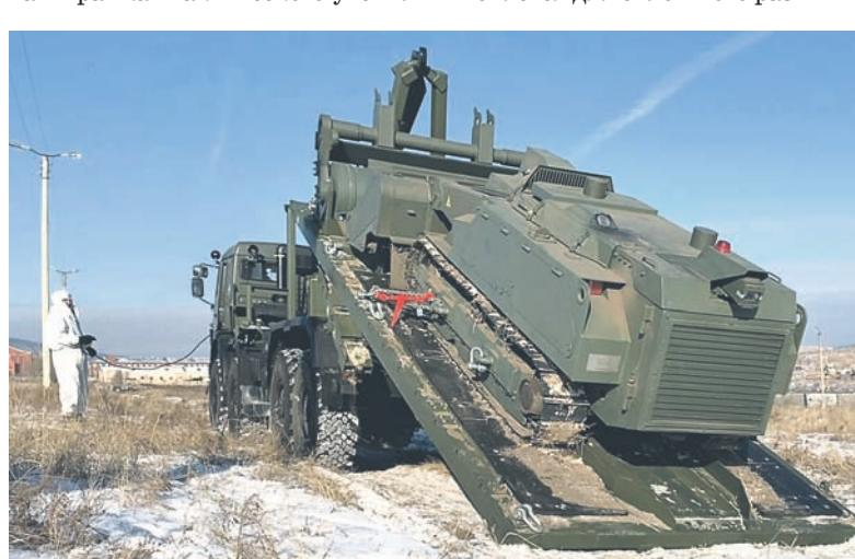
рования местности. Он может управляться дистанционно на расстояния до 1 км. Комплекс оснащён четырьмя видеокамерами, обеспечивающими обзор в 360 градусов. «Уран-6» способен выдергивать взрывы мощностью до четырёх кг тротила, а также преодолевать вертикальную стену высотой до 1 м и ров шириной 1,5 м.
