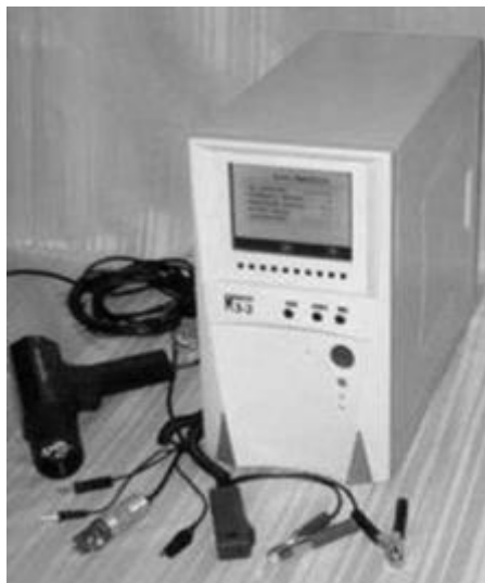
Рис. 5. Приборы и датчики для подключения мотор-тестера
