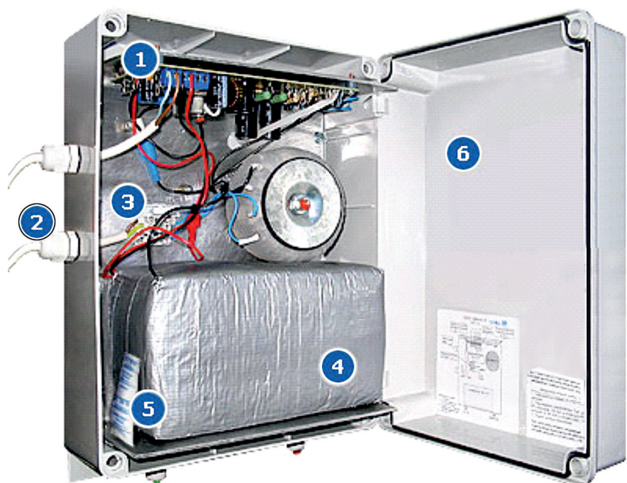
Рис. 1. SKAT-1200 исп. 5: 1 – колодка для подключения нагрузки; 2 – герметичные входы; 3 – колодка подключения входа ~220 В; 4 – аккумулятор в термокожухе (в комплект поставки не входит); 5 – пакет с силикогелем; 6 – корпус с защитой класса IP56
