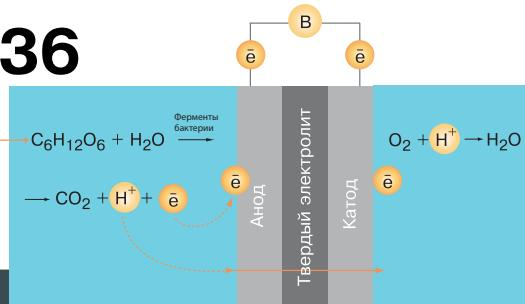
Микробный топливный элемент добывает электричество из органических отходов.
