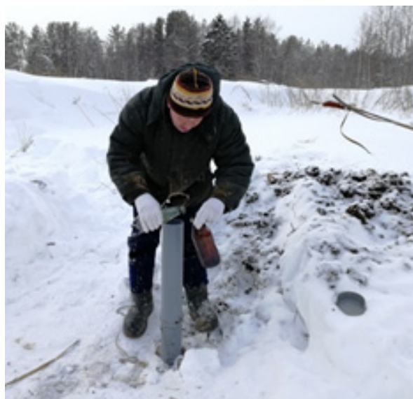
Рис. 2.5. Отбор проб грунтовых вод рядом со свалкой
